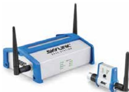
STELLAR è la nuova app di Arri che permette il controllo della luce gestendo automaticamente le complesse impostazioni del DMX, con un design grafico semplice ed estremamente funzionale e intuitivo. Tramite SKYLINK è possibile la comunicazione wireless DMX/RDM con gli apparecchi SkyPanel e L-Series con una connessione diretta alla porta DMX.
